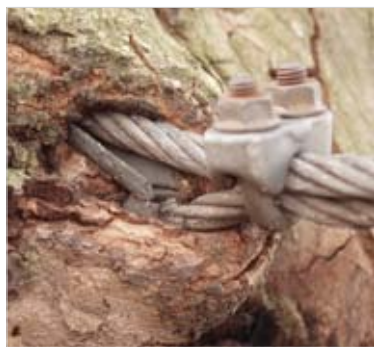
Vollständig eingewachsene Ringmutter und Kausch
