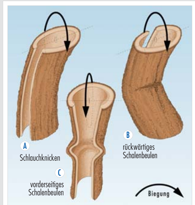
Versagensmuster bei Bäumen mit Innenhöhlung und offenem Stammquerschnitt.
