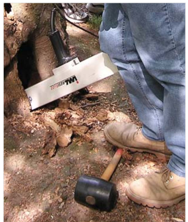
Bohrwiderstandsmessung am Stammfuß
